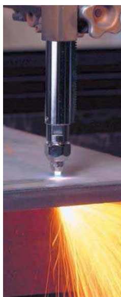
OXYCUT MACH Cannello e punte da taglio con miscelazione nel cannello
